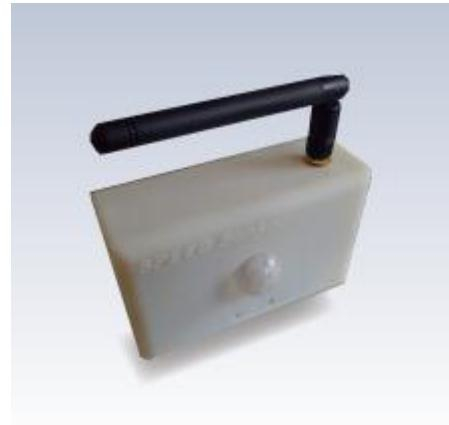
今回の開発では、人感センサーを採用し開発しましたが、センサー部分を変更することで様々な用途に利用することができます。また、センサーデバイス本体は、製品化の段階で半分以下の大きさになる予定です。
